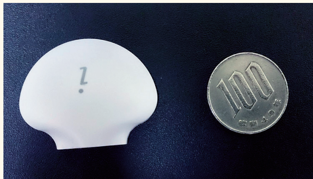
図2 CGM検査用のメモリー装置(センサー針と接続して、身体に貼り付けます。)
