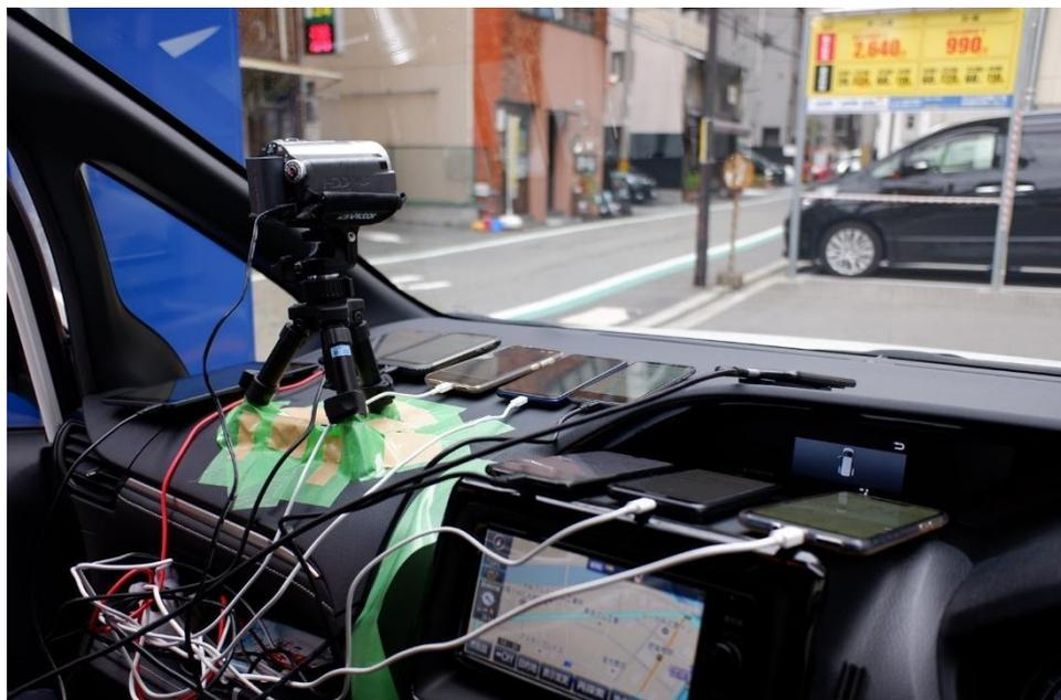
写真 17 車両に搭載した端末と GPS 精度試験の様子
