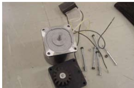
図5 棚駆動用モーター(ボックス内の減速用歯車が破損)
